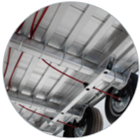
Extrem starke Bodenunterstützung durch viele Rohrprofile
