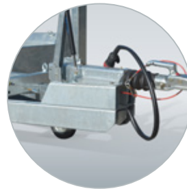
Zubehör; Kupplungserhöhung von 5 oder 10 cm
