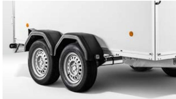
**Wartungsfreie Gummifederachse mit Einzerradaufhängung**
